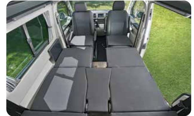
Der Mittelgang zwischen den 2 Einzelbetten sorgt für besten Zugang zu Toilette und Küche. Das Mittelpolster verbindet bei Bedarf beide Betten.
