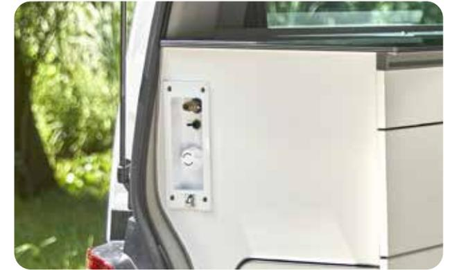
27-l-Frischwassertank und 12-l-Abwasserkanister, optional mit Warmwasserversorgung und Anschluss für Außendusche.
