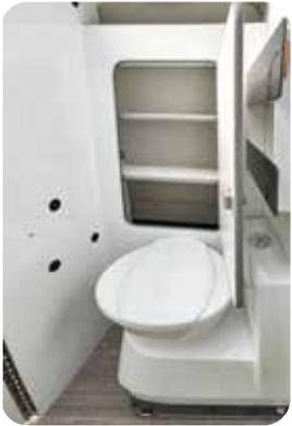
Das WC-Abteil mit fest eingebautem WC im Heck hat eine Abtrennung zum Wohnraum und verschwindet bei Nichtgebrauch platzsparend hinter der Tür.
